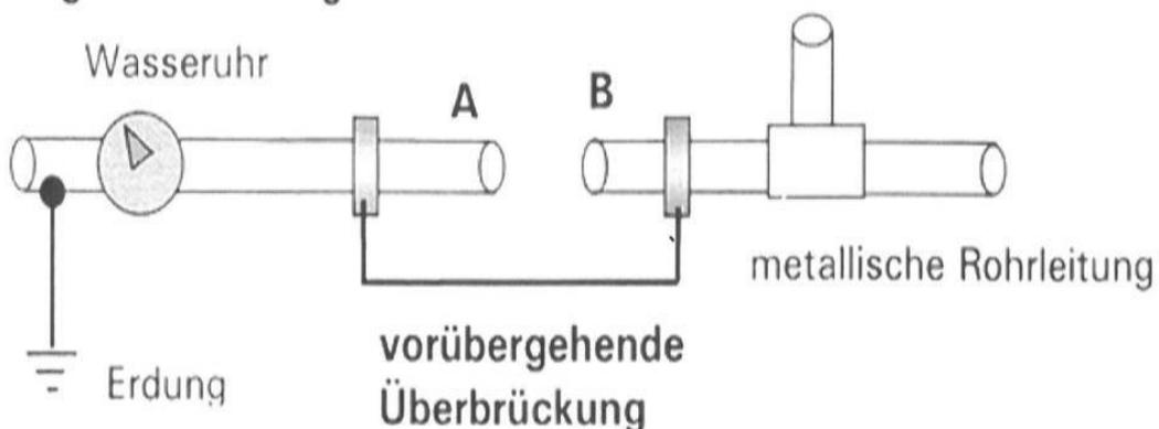
Nachdem die vorübergehende elektrische Überbrückung installiert ist, darf die Trennung der Rohrleitung erfolgen und das **WATERCAT®** System eingebaut werden. Selbstverständlich sind die Wasserventile vor der Trennung zu schließen.
