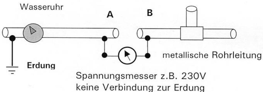
Um dieser Gefahr vorzubeugen, muss vor Trennung der Rohrleitung eine elektrische Überbrückung über die Rohrenden **A** und **B** installiert werden. Mit 2 Bänderungsschellen und einem hochflexiblen isolierten Kupferseil mit mindestens 16mm<sup>2</sup> Querschnitt bei einer maximalen Länge von 3 m, wird eine vorübergehende elektrische Überbrückung hergestellt.
