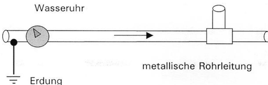
Der Einbau eines **WATERCAT®** Wasserbehandlungssystems erfolgt nach der Wasseruhr. Um das System in die Wasserleitung einzubauen, muss diese aufgetrennt werden. Das hat zur Folge, dass es zu einer elektrischen Unterbrechung kommt und somit die Leitung gegen Berührungsspannung nicht mehr geerdet ist. Wenn der Monteur die Rohrleitungsenden **A** und **B** anfasst, überbrückt er die Unterbrechung. Das kann unter ungünstigen Umständen lebensgefährlich sein.
