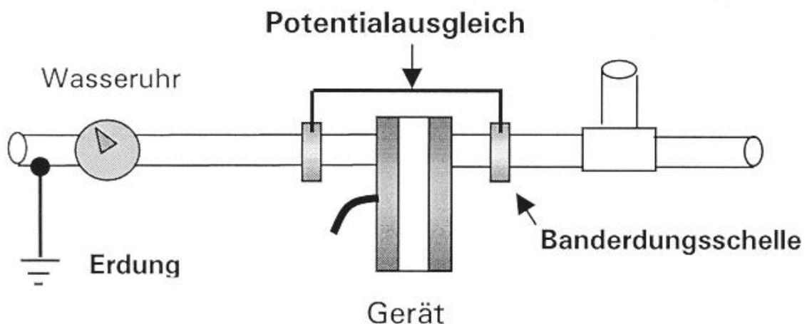
Wurden ein Filter oder weitere Geräte in die Rohrleitung eingebaut, ist die gesamte Strecke der eingebauten Geräte zu überbrücken.
